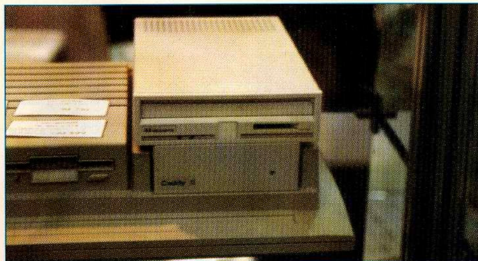
Le "Caddy II", ou comment installer un lecteur au format 5"25 sur un Mega STE ou un TT... — Ci-dessous, un lecteur "floptical" : 720 Ko ou 1.44 Mo sur disquettes magnétiques, 21 Mo sur support optique. Encore un peu cher.
